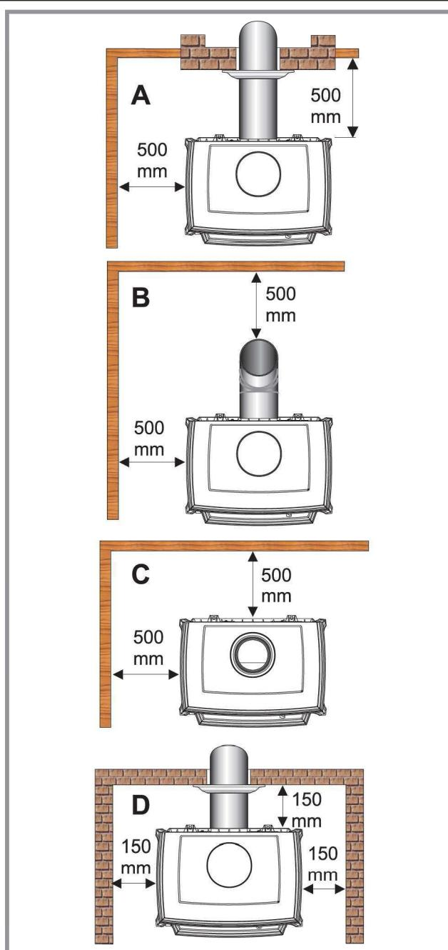
Figuur 2 - Minimale veiligheidstaafstand
