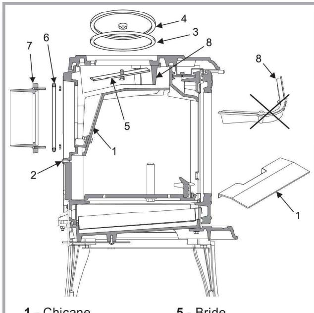
*Figure 4 - Départ des fumées à l'arrière*
